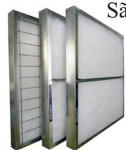
São fabricadas em camadas sucessivas de fibras com diâmetros diferenciados, distribuídas de forma a obter um material com ou sem densidade progressiva e homogênea em toda superfície. Este processo garante melhor rendimento do produto na filtração, baixa perda de carga e grande capacidade de retenção de pó além de maior vida útil.
